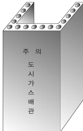
그림 2.5.7.3.3③ 철근콘크리트 방호조치
