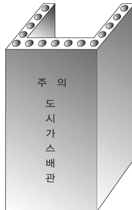
그림 2.5.7.3.3③ 철근콘크리트 방호조치
