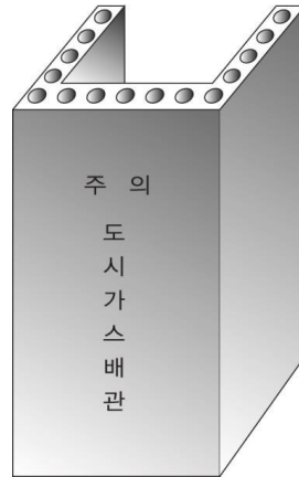
그림 2.5.7.3.3③ 철근콘크리트 방호조치
