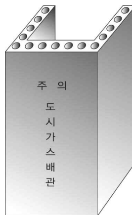
그림 2.5.7.3.3③ 철근콘크리트 방호조치
