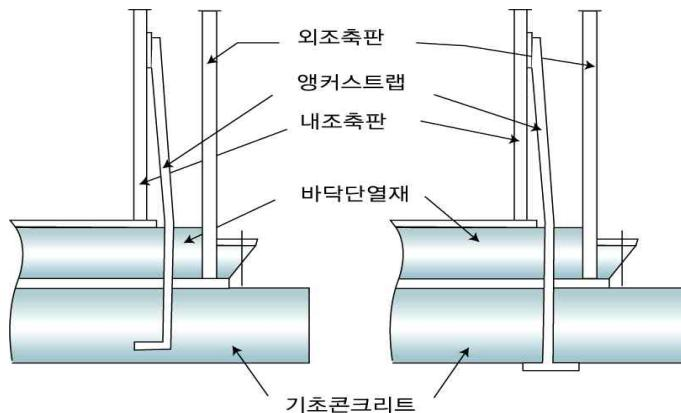
그림 2.2.3.7 평저원통형 저장탱크의 앵커스트립 설치방법
