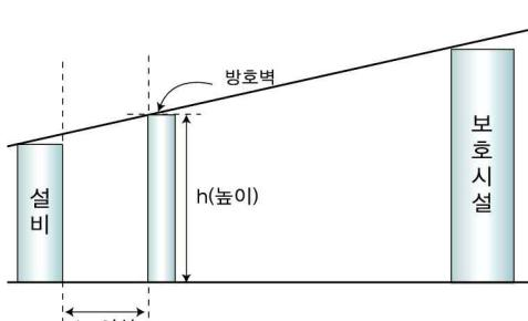
그림 2.7.2.1.2① 방호벽 설치 예(측면도)
