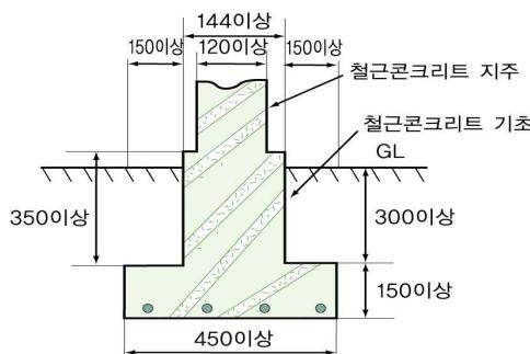
그림 2.7.2.1.2 철근콘크리트제 방호벽 설치 예
