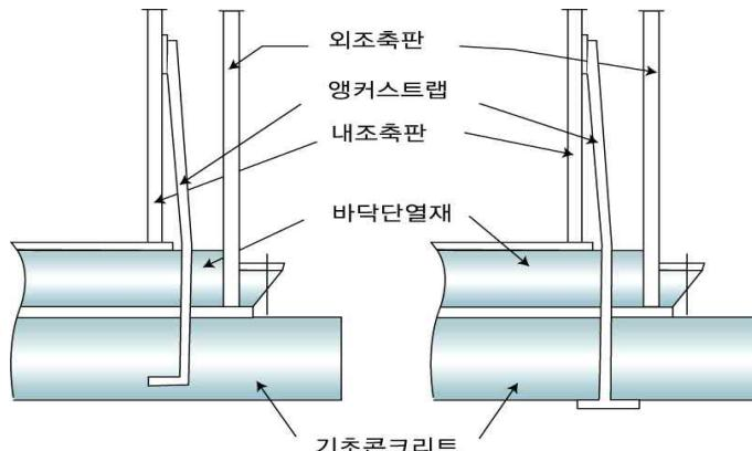
그림 2.2.3.7 평저원통형 저장탱크의 앵커스트랩 설치방법
