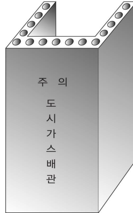
그림 2.5.7.3.3③ 철근콘크리트 방호조치
