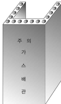
그림 2.5.7.3.2(3) 철근콘크리트제 방호구조물 예시
