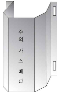
그림 2.5.7.3.2(1) 방호철판을 사용한 방호구조물 예시
