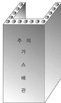
그림 2.5.7.3.2(3) 철근콘크리트제 방호구조물 예시
