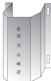
그림 2.5.7.3.2(1) 방호철판을 사용한 방호구조물 예시
