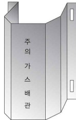
그림 2.5.7.3.2(1) 방호철판을 사용한 방호구조물 예시
