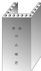
그림 2.5.7.6.9(2)③ “ㄷ” 형태의 철근콘크리트제 방호구조물에 의한 방호조치
