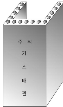
그림 2.5.8.3.2(3) 철근콘크리트재 방호구조물 예시
