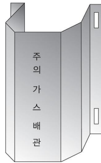
그림 2.5.7.3.2(1) 방호철판을 사용한 방호구조물 예시
