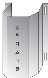
그림 2.5.7.3.2(1) 방호철판을 사용한 방호구조물 예시
