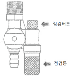
그림 3.8.3.4.1② 점검통 구조 예시
