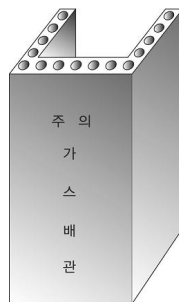
그림 2.5.7.6.11(2)③ “ㄷ” 형태의 철근콘크리트제 방호구조물에 의한 방호조치
