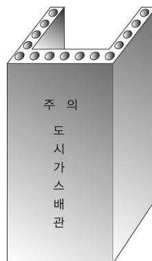
그림 2.5.4.3.3③ “ㄷ” 형태의 철근콘크리트재 방호구조물
