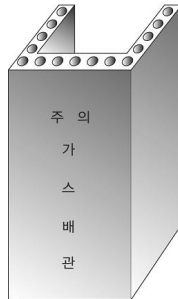
그림 2.5.7.6.11(2)③ “ㄷ” 형태의 철근콘크리트제 방호구조물에 의한 방호조치
