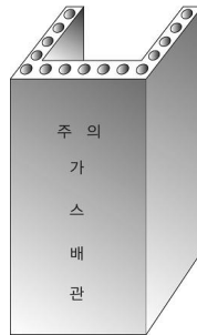
그림 2.5.7.6.9(2)③ “ㄷ” 형태의 철근콘크리트제 방호구조물에 의한 방호조치
