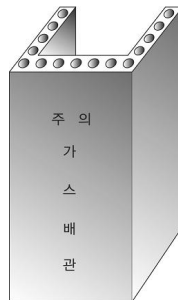
그림 2.5.7.6.9(2)③ “ㄷ” 형태의 철근콘크리트제 방호구조물에 의한 방호조치
