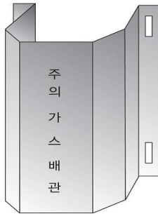
그림 2.5.7.6.9(2)① “ㄷ” 형태로 가공한 철판제 방호구조물에 의한 방호조치
