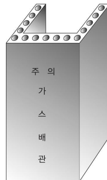
그림 2.5.8.3.2(3) 철근콘크리트재 방호구조물 예시
