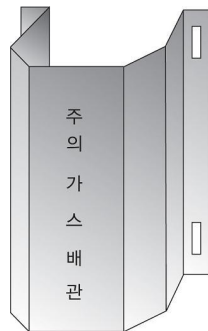
그림 2.5.7.3.2(1) 방호철판을 사용한 방호구조물 예시
