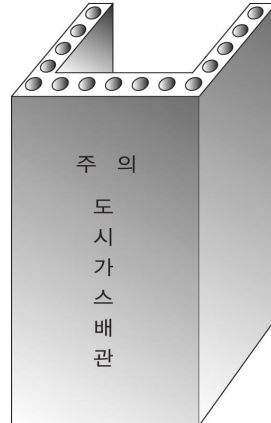
그림 2.5.8.3.3③ 철근콘크리트 방호조치
