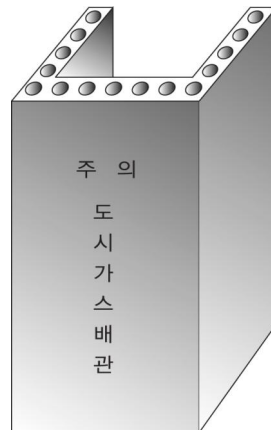
그림 2.5.7.3.3③ 철근콘크리트 방호조치
