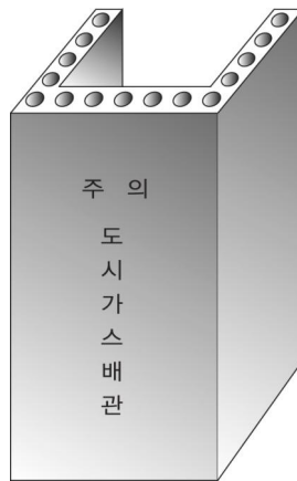
그림 2.5.7.3.3③ 철근콘크리트 방호조치
