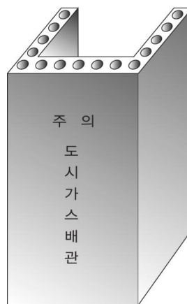
그림 2.5.7.3.3③ 철근콘크리트 방호조치
