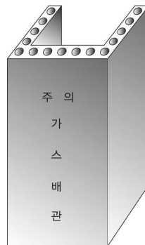
그림 2.5.7.3.2(3) 철근콘크리트제 방호구조물 예시
