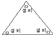
설비군 바닥면 둘레 = 실선부분 길이 그림 2.6.2.4② 여러 개의 설비를 한 개의 군으로 형성하는 방법
