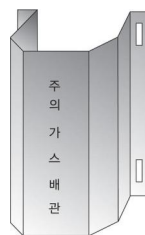
그림 2.5.7.3.2(1) 방호철판을 사용한 방호구조물 예시
