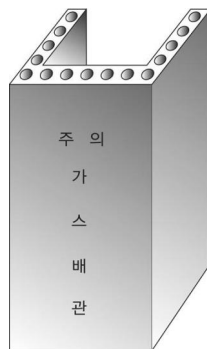
그림 2.5.7.3.2(3) 철근콘크리트제 방호구조물 예시
