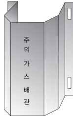
그림 2.5.7.3.2(1) 방호철판을 사용한 방호구조물 예시
