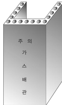
그림 2.5.7.3.2(3) 철근콘크리트재 방호구조물 예시
