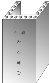
그림 2.5.7.3.2(3) 철근콘크리트재 방호구조물 예시
