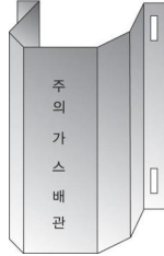
그림 2.5.7.3.2(1) 방호철판을 사용한 방호구조물 예시
