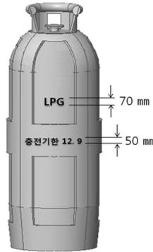
그림 3.12.2.3 액화석유가스용 복합재료용기 문자 및 그림의 크기 <개정 14.11.17>
