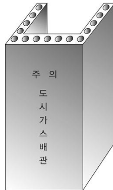
그림 2.5.4.3.3③ “ㄷ” 형태의 철근콘크리트재 방호구조물
