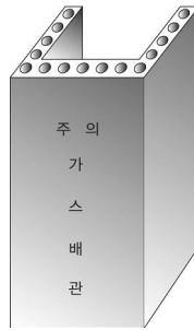
그림 2.5.7.6.11(2)③ “ㄷ” 형태의 철근콘크리트제 방호구조물에 의한 방호조치
