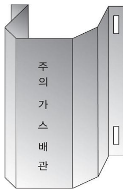
그림 2.5.7.6.11(2)① “ㄷ” 형태로 가공한 철판제 방호구조물에 의한 방호조치
