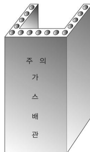
그림 2.5.7.6.11(2)③ “C” 형태의 철근콘크리트제 방호구조물에 의한 방호조치
