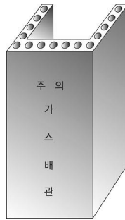
그림 2.5.7.6.9(2)③ “ㄷ” 형태의 철근콘크리트제 방호구조물에 의한 방호조치
