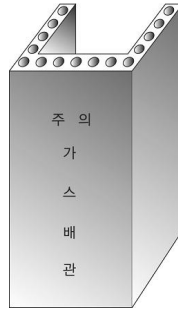
그림 2.5.7.6.9(2)③ “ㄴ” 형태의 철근콘크리트제 방호구조물에 의한 방호조치
