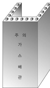
그림 2.5.7.6.9(2)③ “ㄷ” 형태의 철근콘크리트제 방호구조물에 의한 방호조치
