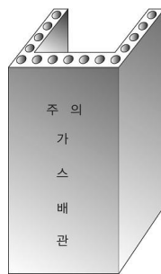
그림 2.5.7.6.9(2)③ “ㄷ” 형태의 철근콘크리트제 방호구조물에 의한 방호조치
