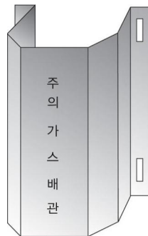
그림 2.5.7.3.2(1) 방호철판을 사용한 방호구조물 예시
