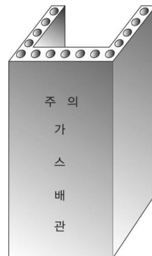
그림 2.5.8.3.2(3) 철근콘크리트재 방호구조물 예시
