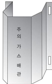
그림 2.5.7.3.2(1) 방호철판을 사용한 방호구조물 예시
