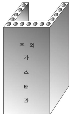
그림 2.5.8.3.2(3) 철근콘크리트재 방호구조물 예시
