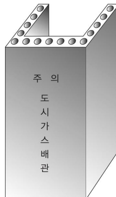
그림 2.5.8.3.1(4)③ “ㄷ” 형태의 철근콘크리트재 방호구조물
