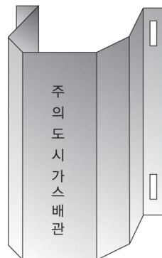
그림 2.5.8.3.1(4)① “ㄷ” 형태로 가공한 방호철판에 의한 방호구조물
