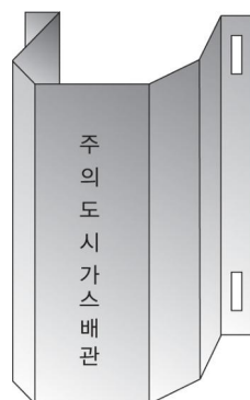
그림 2.5.8.3.1(4)① “ㄷ” 형태로 가공한 방호철판에 의한 방호구조물
