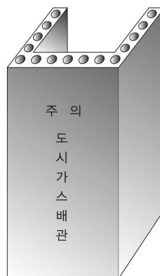
그림 2.5.8.3.1(4)③ “C” 형태의 철근콘크리트재 방호구조물
