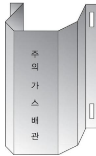
그림 2.5.7.3.2(1) 방호철판을 사용한 방호구조물 예시
