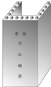
그림 2.5.7.3.2(3) 철근콘크리트제 방호구조물 예시
