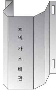
그림 2.5.7.3.2(1) 방호철판을 사용한 방호구조물 예시
