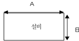
설비군 바닥면 둘레 = 2A+2B 그림 2.6.2.4① 개별설비마다 형성하는 방법
