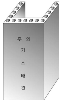
그림 2.5.7.3.2(3) 철근콘크리트재 방호구조물 예시
