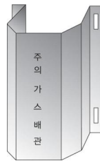
그림 2.5.7.3.2(1) 방호철판을 사용한 방호구조물 예시
