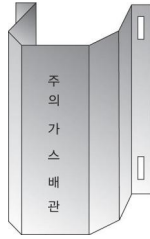
그림 2.5.7.3.2(1) 방호철판을 사용한 방호구조물 예시
