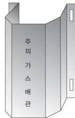
그림 2.5.7.3.2(1) 방호철판을 사용한 방호구조물 예시
