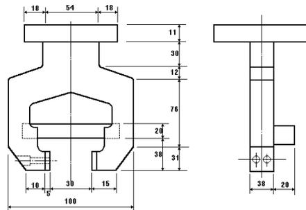
그림 3.11.2.2 밸브 부착 치구(예시)
